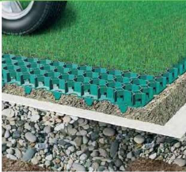
sobre el que se colocará el pavimento drenante de celosía sobre una capa drenante de grava de 15 cm de espesor y una capa de nivelación de arena de 4 cm de espesor sobre la que se dispone una rejilla alveolar de polietileno de alta densidad.
